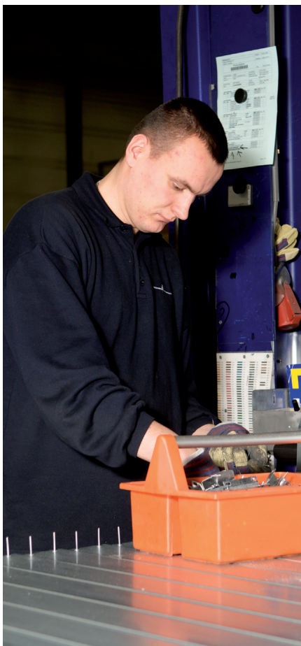
Vaklui van Metacon uit Gouda voorzien dubbelwandige brandvertragende rolluiken van nagels die de lamellen bij elkaar houden.
