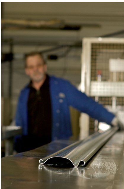
Een rolvormmachine maakt de lamellen op maat.
