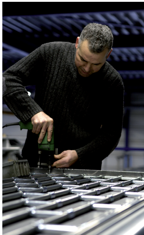
Het speerpunt van Metacon is zoveel mogelijk te automatiseren, maar sommige zaken worden nog altijd met de hand gedaan, zoals de afwerking van dit buizenrolhek.
